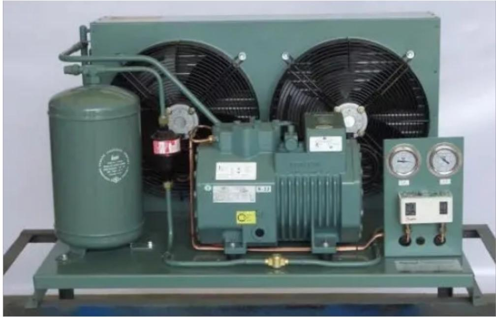
制冷机[refrigerating machine]将具有较低温度的被冷却物体的热量转移给环境介质从而获得冷量的机器。从较低温度物体转移的热量习惯上称为冷量。制冷机内参与热力过程变化（能量转换和热量转移）的工质称为制冷剂。制冷的温度范围通常在120K以上[120K以下属深低温技术范围]。制冷机广泛应用于工农业生产和日常生活中。空调即房间空气调节器(room air conditioner)是一种用于给房间(或封闭空间、区域)提供处理空气的机组。它的功能是对该房间(或封闭空间、区域)内空气的温度、湿度、洁净度和空气流速等参数进行调节，以满足人体舒适或工艺过程的要求。是将压缩机送出的高压高温的制冷剂蒸气冷凝成液体。常用的冷凝器有三类：①水冷式。以水作为冷却剂，有管式冷凝器、套管式冷凝器及螺旋板式冷凝器。②喷淋式。同时以水和空气作为冷却剂，有喷淋式冷凝器（空气为自然对流）和蒸发式冷凝器（空气为强制对流）。③空冷式。以空气作为冷却剂，即空气冷凝器。
