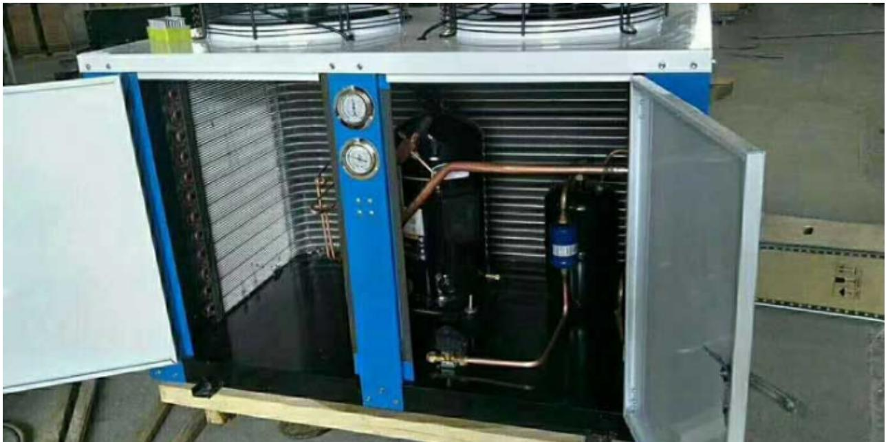
单级蒸汽压缩制冷系统，是由制冷压缩机、冷凝器、节流阀和蒸发器四个基本部件组成。它们之间用管道依次连接，形成一个密闭的系统，制冷剂在系统中不断地循环流动，发生状态变化，与外界进行热量交换。液体制冷剂在蒸发器中吸收被冷却的物体热量之后，汽化成低温低压的蒸汽、被压缩机吸入、压缩成高压高温的蒸汽后排入冷凝器、在冷凝器中向冷却介质(水或空气)放热，冷凝为高压液体、经节流阀节流为低压低温的制冷剂、再次进入蒸发器吸热汽化，达到循环制冷的目的。这样，制冷剂在系统中经过压缩、冷凝、节流、蒸发四个基本过程完成一个制冷循环。<sup>[6]</sup>在制冷系统中，蒸发器、冷凝器、压缩机和节流阀是制冷系统中必不可少的四大件，这当中蒸发器是输送冷量的设备。制冷剂在其中吸收被冷却物体的热量实现制冷。压缩机是心脏，起着吸入、压缩、输送制冷剂蒸汽的作用。冷凝器是放出热量的设备，将蒸发器中吸收的热量连同压缩机做功所转化的热量一起传递给冷却介质带走。节流阀对制冷剂起节流降压作用、同时控制和调节流入蒸发器中制冷剂液体的数量，并将系统分为高压侧和低压侧两大部分。实际制冷系统中，除上述四大件之外，常常有一些辅助设备。
